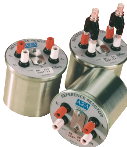
Résistance de référence type CER6000-RR avec différentes étendues de résistance
