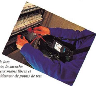
Particulièrement utile lors des mesures de terrain, la sacoche permet d'avoir les deux mains libres et ainsi de changer rapidement de points de test.
