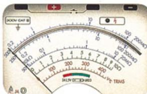
Les graduations logarithmiques des mesures d'isolement évitent les changements d'échelles lors de la lecture. Les couleurs communes entre le cadran et le rotacteur permettent une identification immédiate de la fonction. Le voyant de présence de tension est clairement visible.
