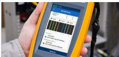
Identifier les défauts du cuivre
