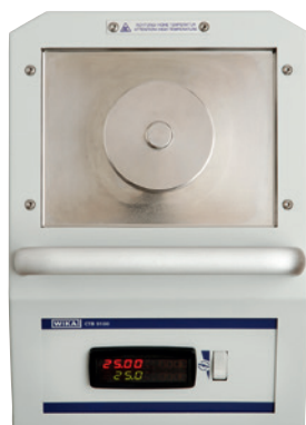
Micro-bains d'étalonnage, type CTB9100-165 avec couvercle à visser
