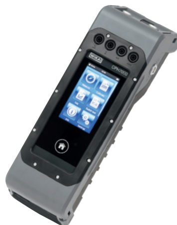
Calibrateur de pression type CPH7000
