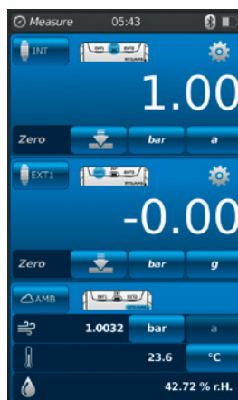
Représentation des chaînes de mesure possibles
